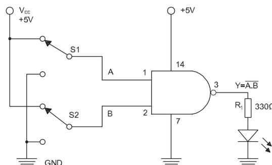
CONSTRUCTION OF NAND GATE USING IC 7400
