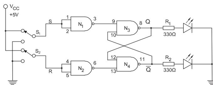
R-S FLIP-FLOP CIRCUIT USING NAND GATE
